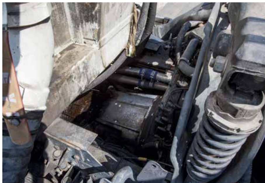
O sistema de arrefecimento da caixa de velocidades foi projetado e executado nas instalações da Driveline
